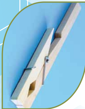
Pinza de madera Broche con un brazo largo, para sujetar tubos de ensayo u otros objetos, como termómetros.
