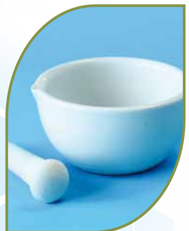
Mortero con pilón De cerámica enlozado, se utiliza para moler o hacer polvo sustancias duras o semiduras.
