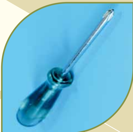
Destornillador Phillips ph2 Para tornillos con cabeza con ranura en cruz.
