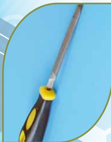
Lima triangular Lima de grano medio de tres caras, para marcar y señalar tubos de vidrio que se deben cortar.
