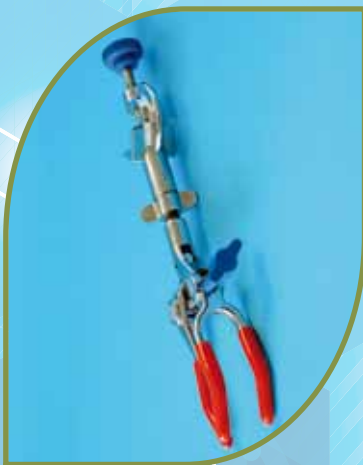
Pinza con nuez de ajuste al vástago Dispositivo de tres partes que sirve para fijar al vástago del soporte universal, materiales de laboratorio y otros objetos.
